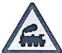
(Biển báo giao nhau với đường sắt không có rào chắn)
