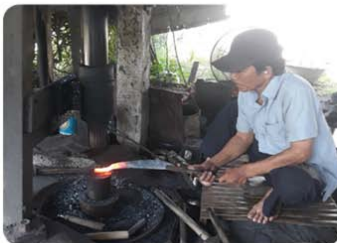
Hình 4.2. Tạo dáng cho công cụ trong nghề rèn ở xã Tịnh Minh, huyện Sơn Tịnh
